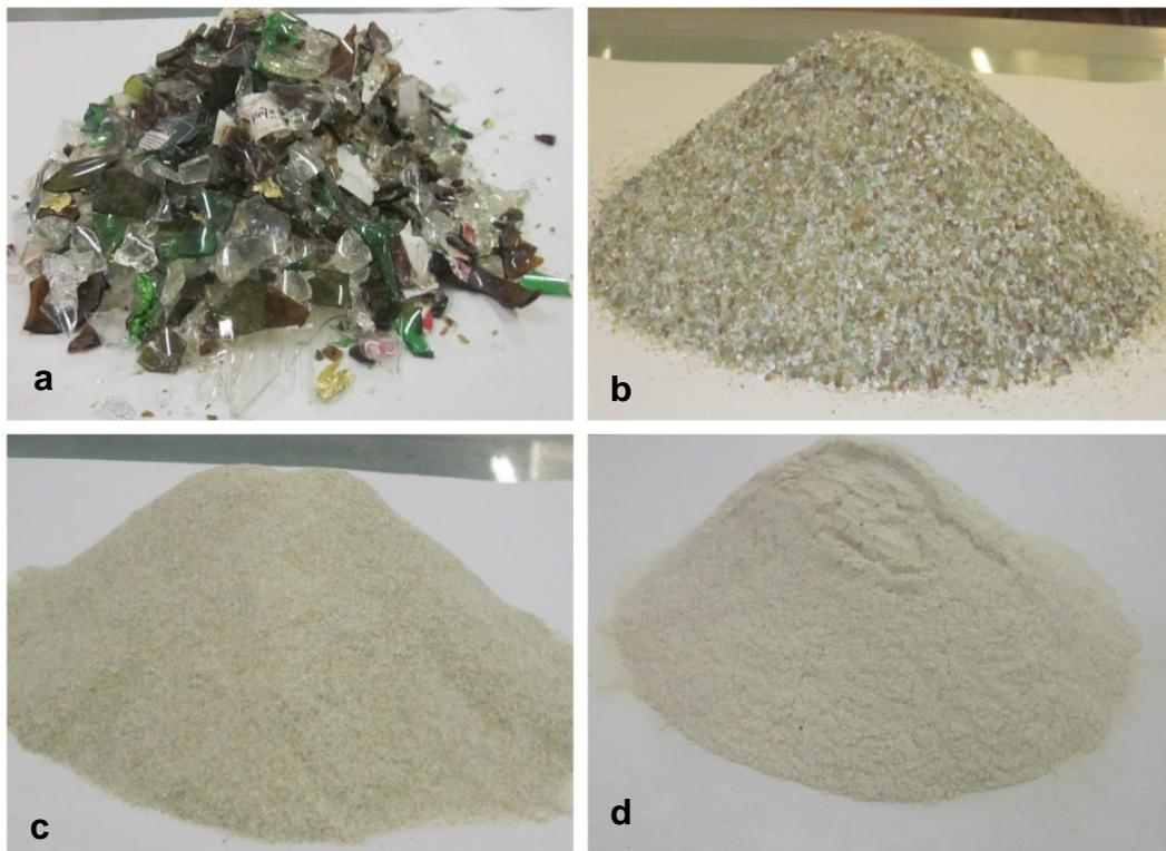
Figure 4-2 : Ground glass: (a) Raw (b) Coarse size (c) Medium size (d) Fine size
