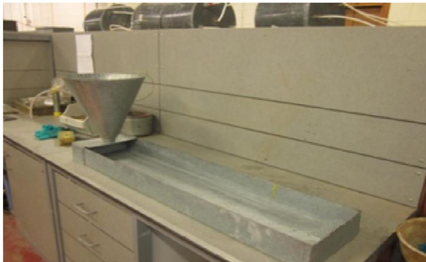
*Figure 4-6 : Flow test apparatus*
