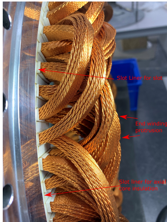
(d) Wound stator, End Winding zoom in
